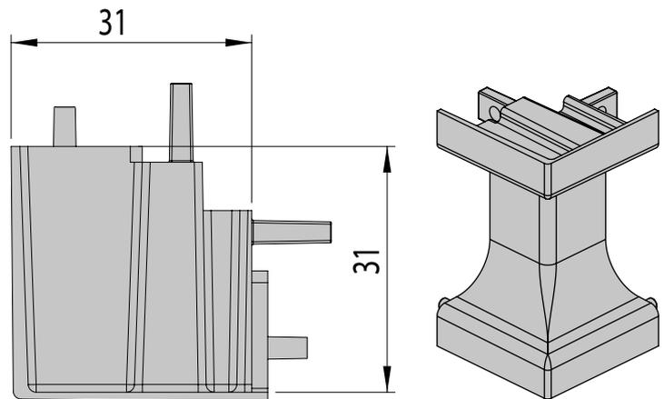
Com conexão interna descontar 32mm / conector
