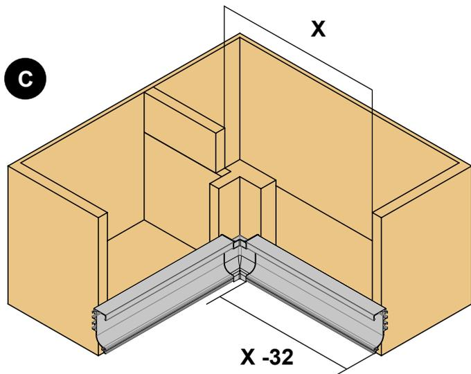
Com ponteira lateral descontar 2mm /ponteira
