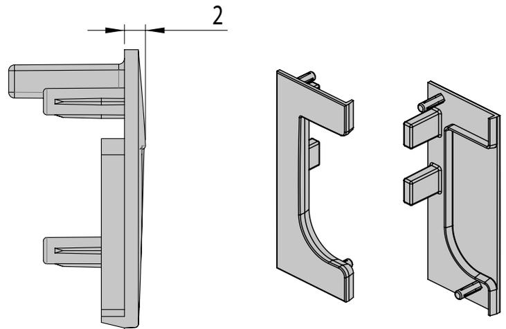
Com conexão canto externo descontar 31mm / conector
